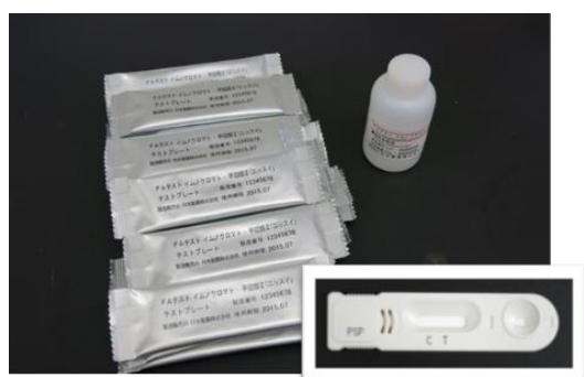
図1. MTテスト イムノクロマト-PSP「ニッセイ」の構成
