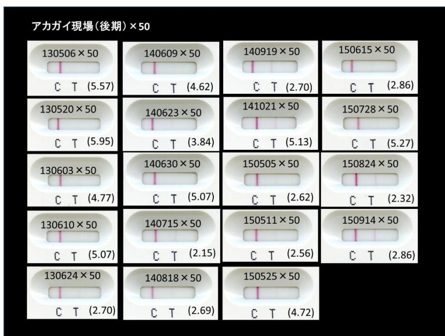
図4 2013年～2015年に大阪湾で採取したアカガイのキットによる分析(後期50倍希釈、 ( )内はマウス毒量)。
